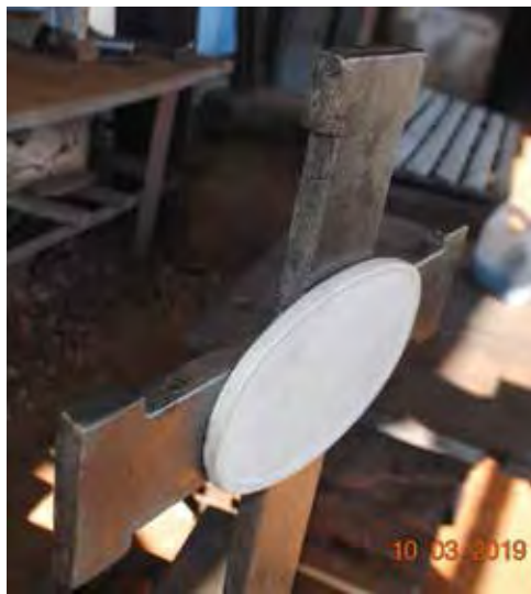
Pôvodne sa štítky na osobné údaje prilepili na kríž špeciálnym lepidlom. Táto metóda sa však neosvedčila. Foto: Ing. Miroslav Mičianik
